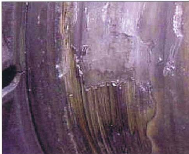
Abb. 1 zerstörte Lageroberfläche/Elektroerosion durch hochfrequente Störströme
